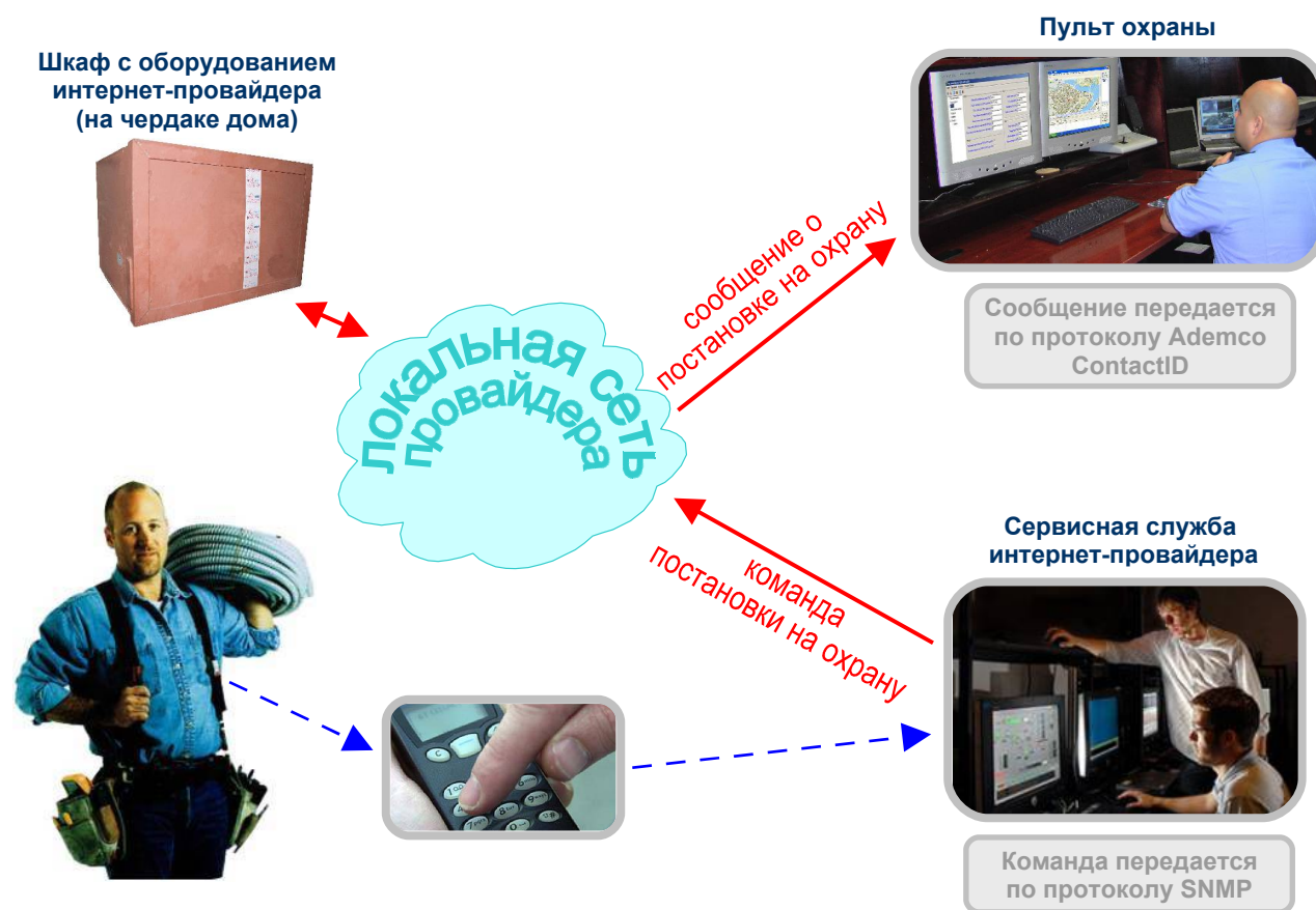
Рис.6.4. Типовое решение №2. Техническое обслуживание шкафа с коммуникационным оборудованием закончено. Шкаф ставится на охрану по команде дежурного сервисной службы интернет-провайдера. На пульт охраны ЧОП передается сообщение о снятии объекта с охраны.
